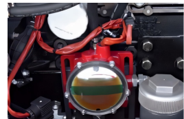
Automatisches Schmierölbetankungssystem Automatic lube oil refuelling system
