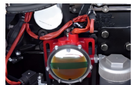
Automatisches Schmierölbetankungssystem Automatic lube oil refuelling system
